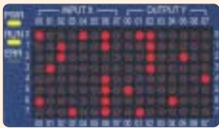
Display Mode 0: displays Input / Output status
